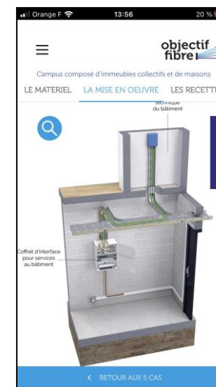
Etape 4 : mise en oeuvre
