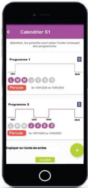
Figure 43 : Module de paramétrage d'un profil nocturne depuis une application sur smartphone.
