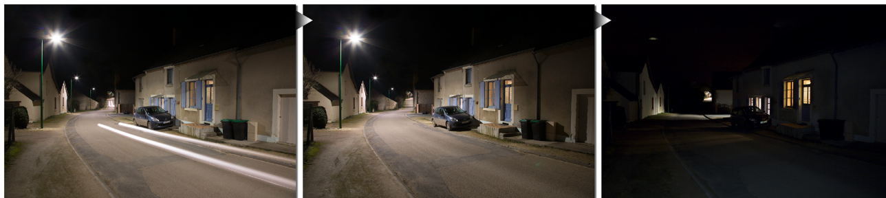
Eclairage par détection de présence - Village du département du Cher (18)
